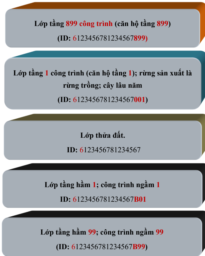
Hình 1. Mã số định danh ID cho thửa đất theo mã kinh tuyến trực
